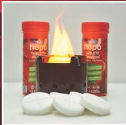
Dimenziije tablete su: prečnik 41,5 mm i visina 10 mm. Masa je oko 14,5 g. Brzina sagorevanja je oko 1 g/min. Temperatura vrha plamena je oko 690°C. Ostatak (pepeo) je maksimum 5%. Dimljenje je manje od 0,2 mg/m<sup>3</sup>, što je izuzetno malo i neprimetno. Tableta može da se zagasi vodom i nakon sušenja opet da se potpali. Neto masa proizvoda 186 g (12 tableta). Bruto masa 215 g. U transportnoj kutiji spakovano je 40 komada proizvoda.
